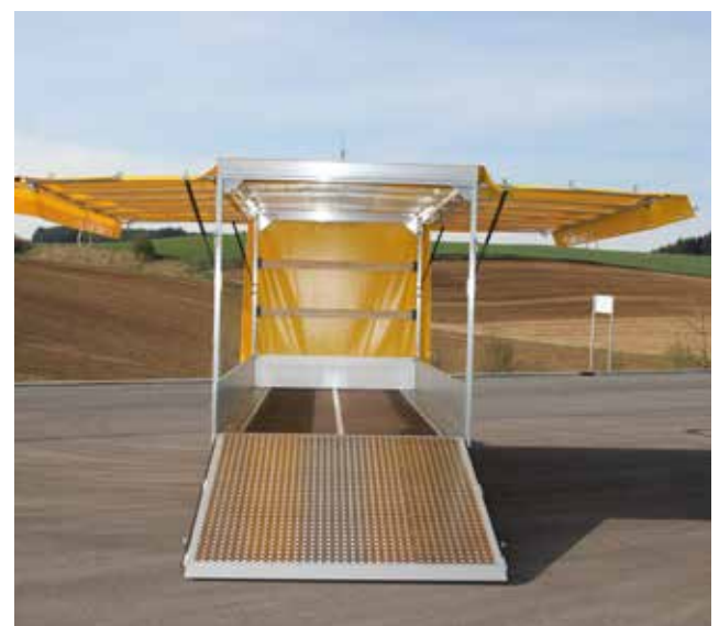
Hochlader Typ UH mit Planenaufbau und Auffahrklappe
