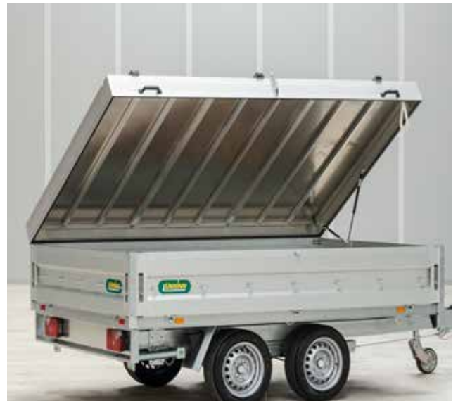
Deckel aus Aluminium für den Schutz des Ladeguts
