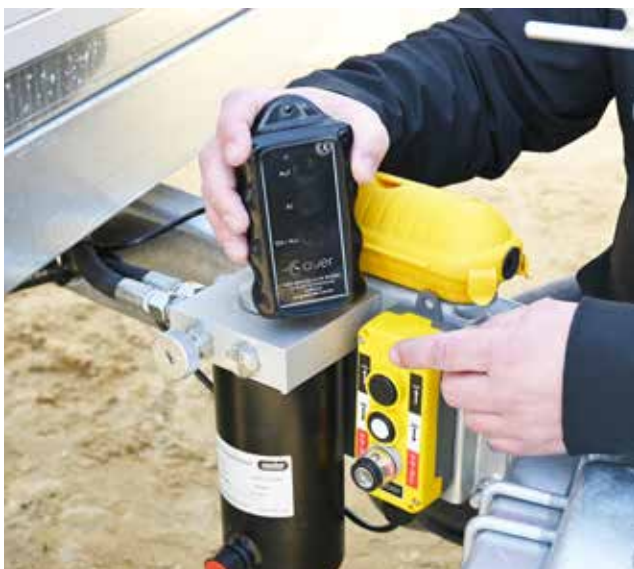
Funkfernbedienung zusätzlich zur Kabelfernbedienung
