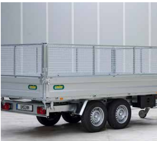
Gitteraufsatz pendelnd gelagert für mehr Ladevolumen
