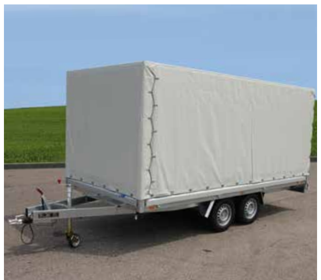
Planenaufbau & Hochplane für wetterfesten Transport
