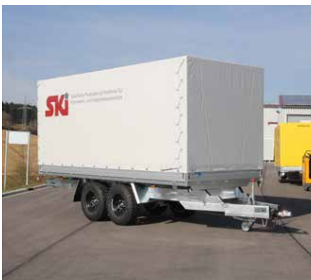
Planenaufbau und Offroadbereifung Typ UH
