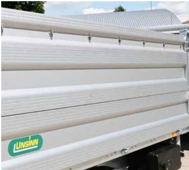
Bordwandaufsatz im UNSINN-Profil pendelnd gelagert
