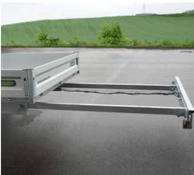
Ausziehbare Stangenleuchte am Leuchenträger montiert
