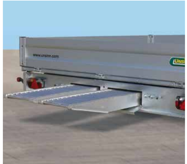
Halterung für Auffahrschienen unter der Ladefläche
