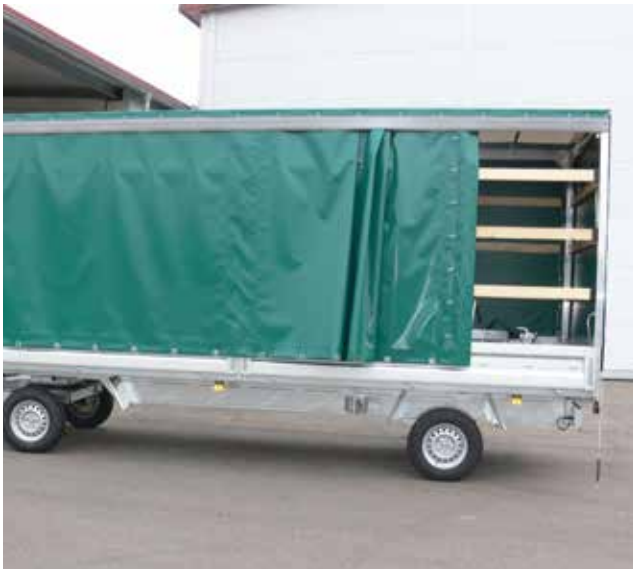
Planenaufbau mit Aluminiumgestell & Schiebeplane
