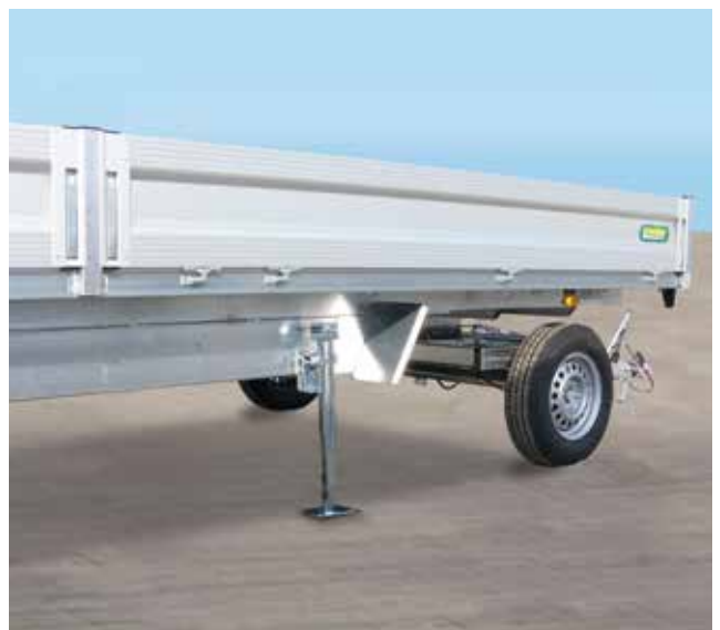
Schwenkbare Kurbelstützen für sicheren Stand
