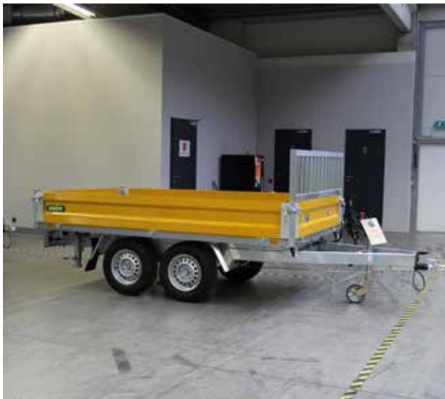
Pulverbeschichtete Bordwände Typ UH (RAL 1021)
