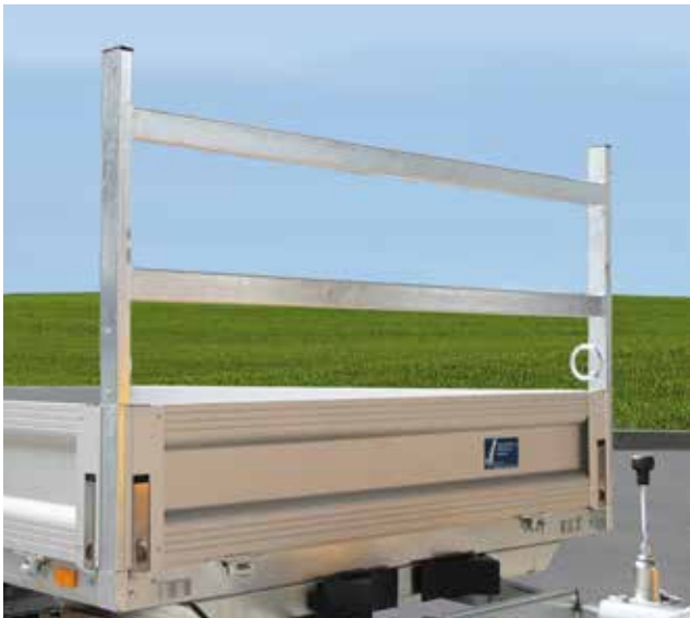
H-Gestell für flexiblere Transportmöglichkeiten
